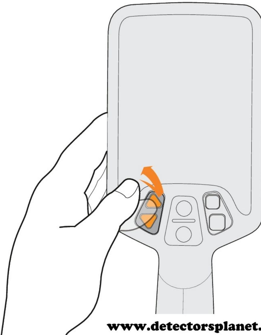
Многие предметы и сооружения, например, линии электропередач, силовые кабели, проводка, могут приводить к возникновению электропомех и ложных сигналов, когда ваш металлоискатель подает сигнал, а под катушкой нет цели. В этом случае пользователь может уменьшить чувствительность, нажав на нижнюю треугольную кнопку. Пользователь также может повысить чувствительность, когда помех нет.
