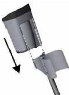
Корпус блока управления должен быть зафиксирован под подлокотником, как показано на рисунке.
