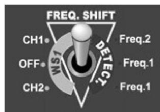
Если Вы работаете ОДИН без беспроводных наушников WS1, ищите при среднем положении переключателя (OFF/Freq.1). Устройство вывода сигнала на беспроводные наушники отключится и не будет потреблять энергию. На детекторе будет установлена частота 1.
