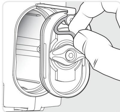
Вставьте батарейки. Обратитесь к схеме ориентации батареек сбоку детектора для того, чтобы батарейки были установлены правильно.
