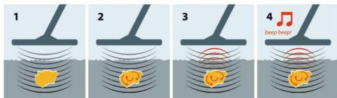
(1) Металлоискатели передают первичное электромагнитное поле в грунт через обмотку передающей катушки. (2) Когда это поле достигает металлических объектов достаточно большого размера, круговые токи (называемые вихревыми токами) генерируются
