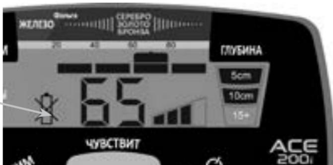
Включается при низком уровне заряда батарей. Металлоискатель сохраняет рабочие функции, но после включения индикатора необходимо выполнить замену батарей. Могут использоваться перезаряжаемые батареи NiMH, хотя такие батареи отличаются меньшим временем действующей зарядки. Батареи, в зависимости от типа и качества, обеспечивают от 20 до 40 часов эксплуатации металлоискателя.
