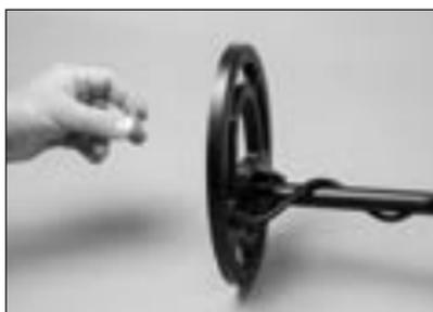
Определившись со способом регистрации объекта поиска, выполните несколько испытаний оборудования на грунте. Создайте "пробный участок" поисков, закопав несколько металлических предметов на определенной глубине.
